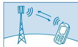
So weiß jede Mobilfunkstation, welche Handys in ihrem Versorgungsbereich eingeschaltet sind. Dieser Bereich, den eine einzelne Mobilfunkstation mit Empfang versorgt, wird auch **Funkzelle** genannt.
