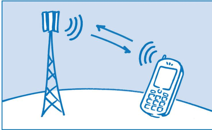
Dieser Datenaustausch zwischen Handy und Mobilfunkantenne erfolgt mit Hilfe von **Funkwellen**. Mit diesen elektromagnetischen Wellen werden Sprache und Daten mit Lichtgeschwindigkeit von deinem Handy zur Antenne und von der Antenne zu deinem Handy übertragen.
