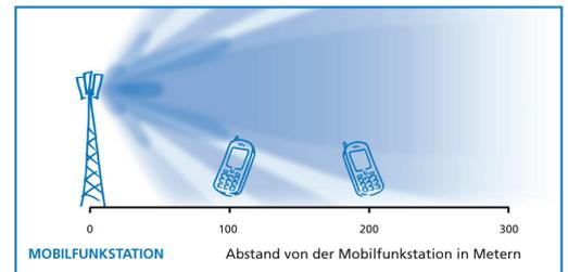
*Schau dir die Grafik genau an. Wo ist die Stärke des elektromagnetischen Feldes intensiver: am Boden direkt unter der Mobilfunkstation oder 150m entfernt in der Hauptsenderichtung der Mobilfunkantenne?*
