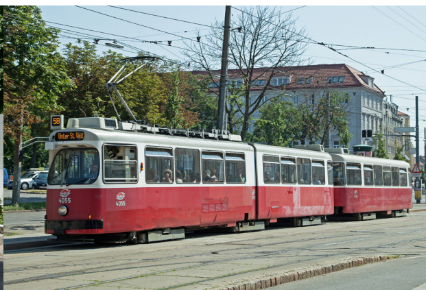
Hochflur Type E 2 mit Beiwagen c 5 Gewicht: 36,5t Länge: 32,1m Fahrgäste: 173 Seit 1978
