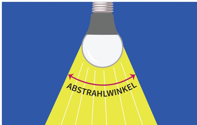
3. » Je größer der Abstrahlwinkel einer Lampe ist, umso **größer** ist die beleuchtete Fläche.
