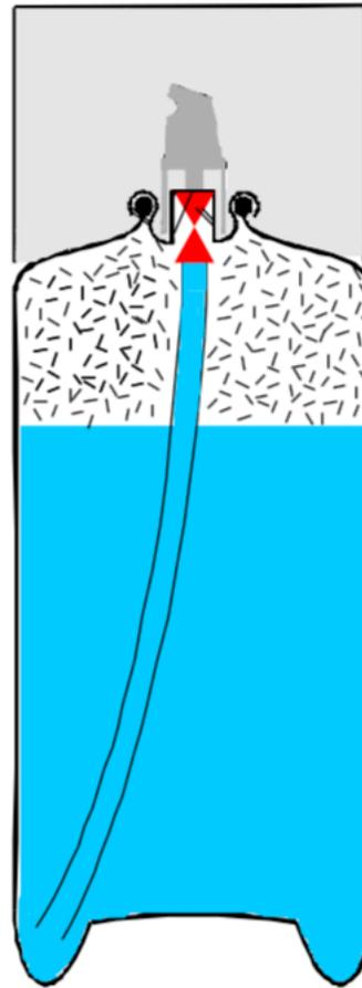
Der Sprühkopf wird befestigt und die Verschlusskappe aufgesetzt.
