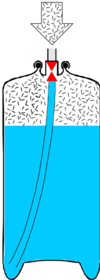
Das Treibmittel wird durch das Ventil in die Dose gepresst. Anschließend wird die Dose in ein heißes Wasserbad (50°C) getaucht. Dadurch wird der Druck im Behälter erhöht und undichte Stellen erkannt werden.
