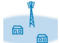
Die einzelnen Funkzellen stehen über Richtfunk oder Kabel mit einer zentralen **Funkvermittlungsstation** in Verbindung. Dieser zentrale Vermittlungscomputer kennt die Standorte aller eingeschalteten Mobiltelefone und leitet Daten von einer Funkzelle an eine andere Funkzelle oder auch ein anderes Telefonnetz weiter.
