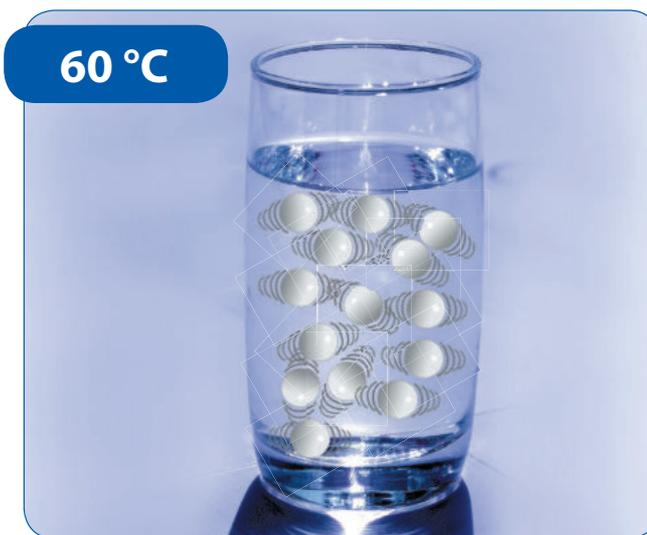
Die Energie wird immer vom **heißeren zum kälteren Körper** übertragen. Das heißt, der heißere Körper kühlt sich ab und erwärmt den kälteren Körper so lange, bis beide die selbe Temperatur erreicht haben. Dieses Prinzip nennt man das **Grundgesetz des Wärmeaustausches**.
